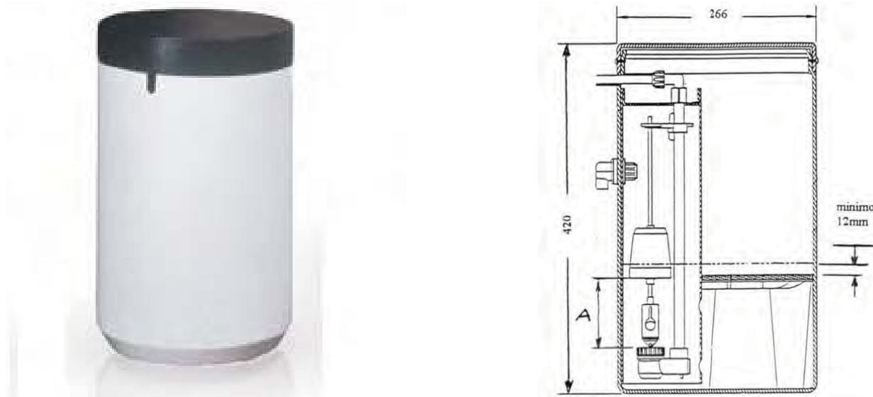
Материал: полиэтилен. Размеры: диаметр 266 мм, высота 420 мм. Максимальное количество засыпанного перманганата калия (KMnO4): 13,6 кг. Соединение – трубка 3/8 ".
