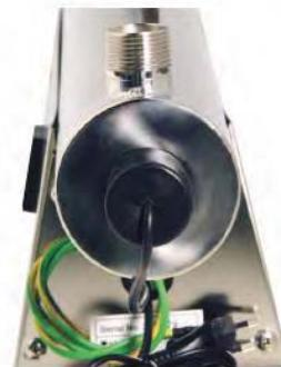
Модель стерилизатора в горизонтальном исполнении с подставкой. Внутри корпуса подставки смонтированы электронные балласты, управляющие розжигом кварцевых ламп. Данная модель стерилизатора оснащена следующими дополнительными опциями: - Счетчик наработки часов. Позволяет отследить количество часов работы оборудования для своевременной замены излучающих кварцевых ламп. Ресурс эффективной работы кварцевых ламп составляет примерно 9000 часов, после чего мощность их излучения начинает снижаться.
