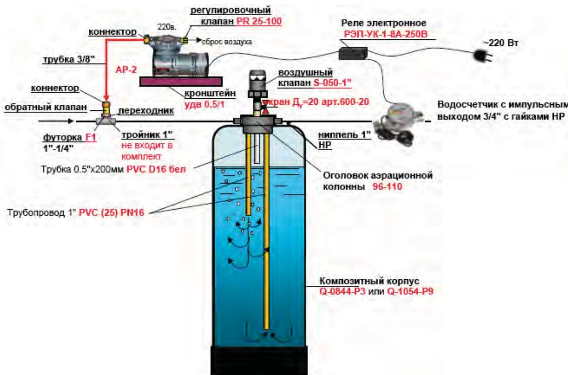
**Аэрационная колонна** предназначается для увеличения времени контакта кислорода воздуха с соединениями железа, находящимися в воде, а также для удаления избытка воздуха и растворенных газов в атмосферу. Аэрационная колонна представляет из себя пластиковый напорный резервуар с системой водоотборных трубок внутри, в верхней части колонны установлен воздуходелительный клапан.
